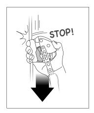
• Después del bloqueo, compruebe que el desbloqueo se efectúa normalmente.
