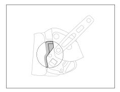
• Compruebe la rotación de la rueda bloqueadora. Haga girar la rueda durante una vuelta completa en los dos sentidos y compruebe que gira de forma uniforme.
