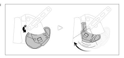
• Compruebe el estado de los topes (marcas, deformación, fisuras...).
