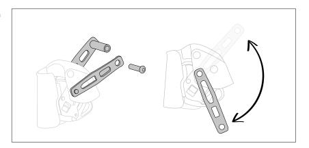
• Vuelva a instalar el absorbedor de energía y cierre la manilla
