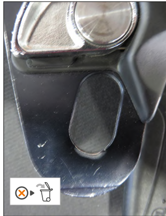
• Orificio de conexión deformado consecuencia de un impacto
