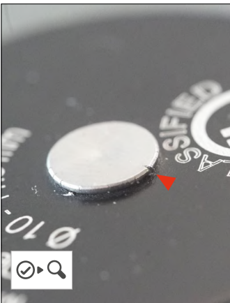
• Remache ligeramente fisurado
