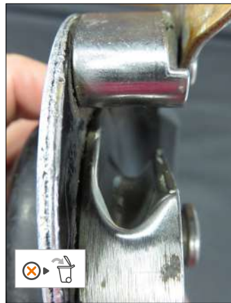
• Testigo de desgaste atacado
